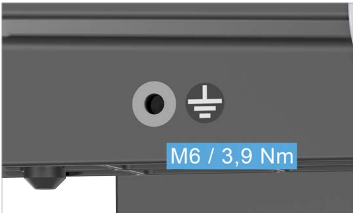
Abb. 5.14: Erdungsschraube am linken Fuß des Wechselrichters
