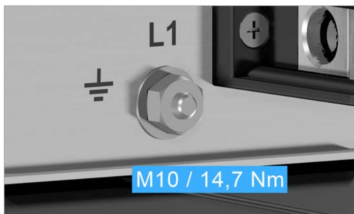
Fig. 5.16: PE connection
