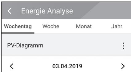
Unter [Energieanalyse] die Option [PV-Diagramm] auswählen.
