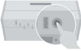
Drücken Sie die WLAN-Taste an der Unterseite des ESS und gehen Sie zum Menü **Einstellungen > WLAN** und wählen Sie **ESS**, um eine Verbindung herzustellen. Das ESS WLAN-Passwort finden Sie auf der rechten Seite des ESS-Geräts unter **WLAN-Passwort**.
