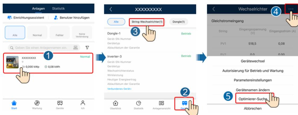
**Schritt 7** Wählen Sie **Geräte** > **Verbundenes Gerät** > **Optimierer**, tippen Sie auf **Optimierernummer**, wählen Sie den defekten Optimierer aus, tippen Sie auf **Gerätewechsel**, und ersetzen Sie den Optimierer, wenn Sie dazu aufgefordert werden.
