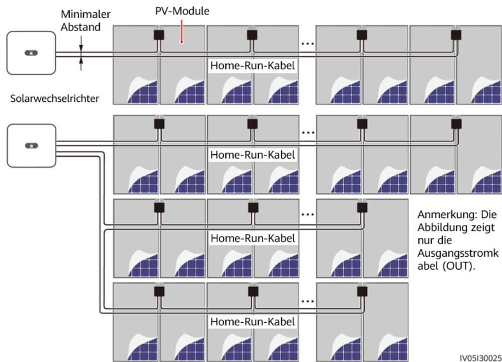
**Abbildung 2-5** Verbotenes Kabelverlegung
