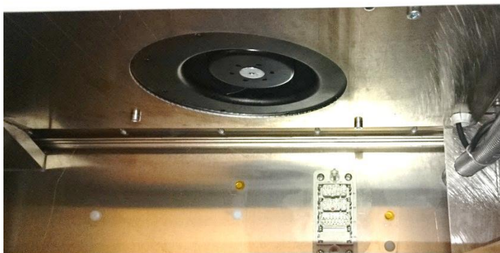
Abbildung 30: Lüfter - Ansicht nach Ausbau des Batteriewechselrichters
