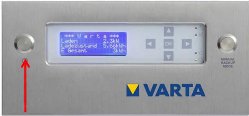
Abbildung 12: Ein/Aus-Taste am Bedienelement des VARTA family/home
