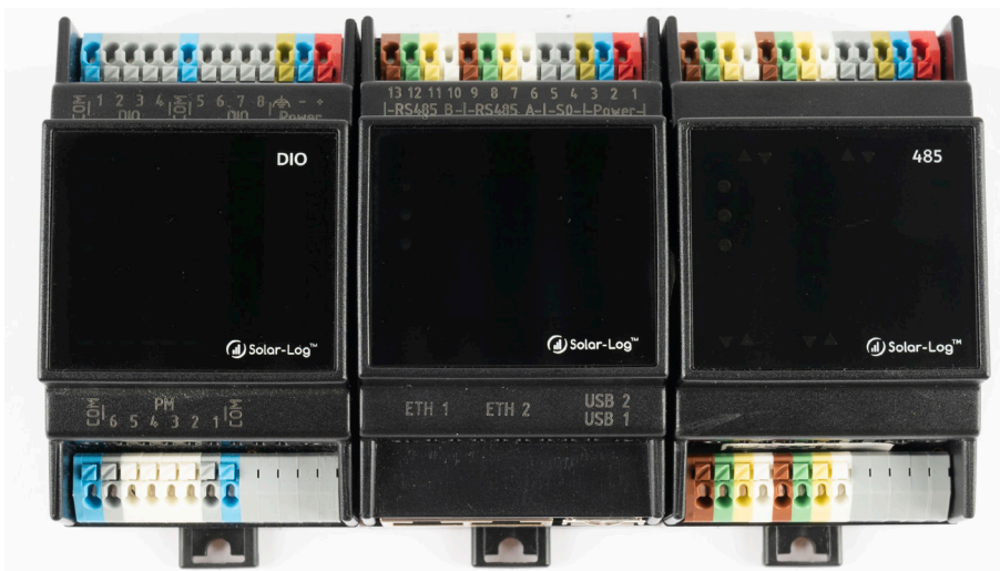
Abb.: Kombination Solar-Log Base mit Solar-Log MOD I/O und Solar-Log MOD 485 (Verbunden - Vorderseite)
