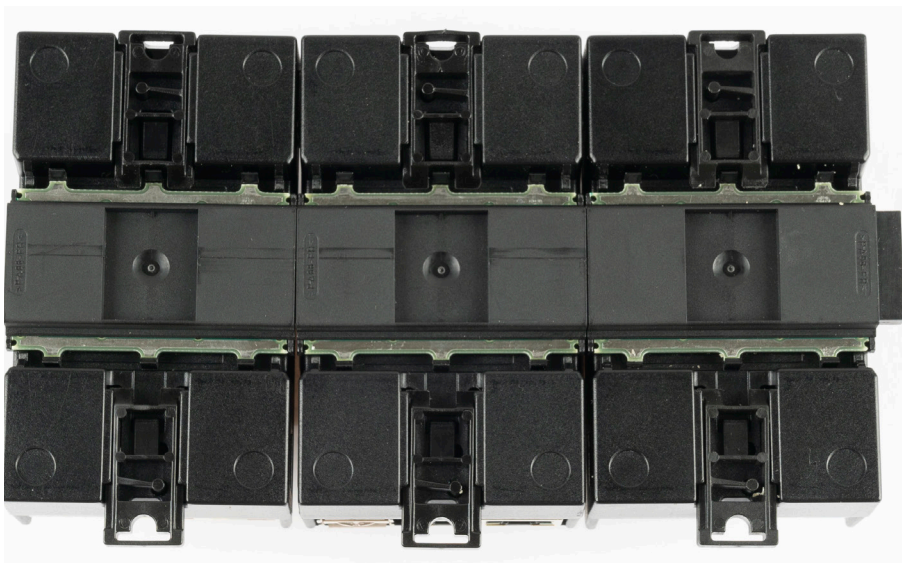
Abb.: Kombination Solar-Log Base mit Solar-Log MOD I/O und Solar-Log MOD 485 (Verbunden - Rückseite)
