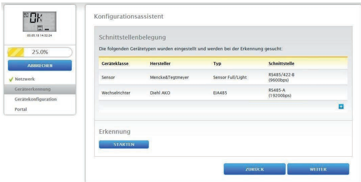
Abb.: Konfigurationsassistent - Beispiel - Schnittstellenbelegung
