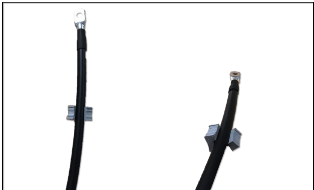
Abb. 48 Icotek-Tülle – für Kabel nicht geeignet
