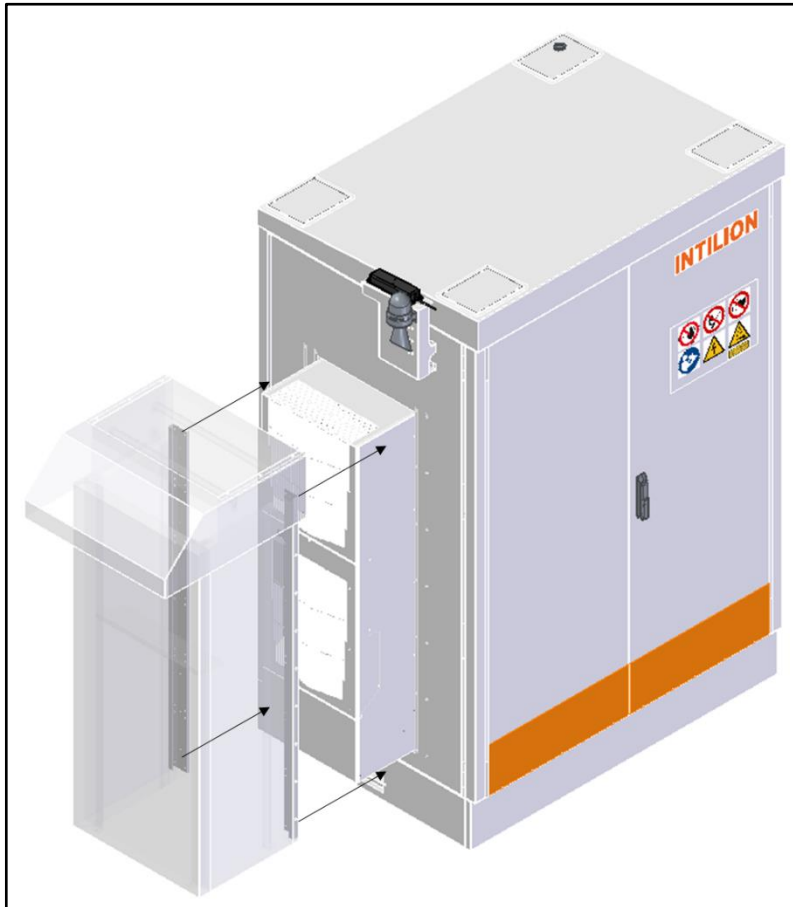
Abb. 57 Batteriespeicher – Schalldämmhaube aufsetzen
