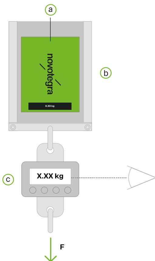
Der Prüfkörper (a) ist entsprechend der geplanten Anlagenausführung mit der vorgesehenen Grundschiene (b) auf die Dachhaut aufzulegen. Folgende Varianten sind möglich:
