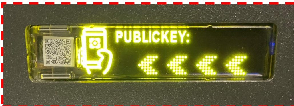
Abbildung 7: Der Public Key des jeweiligen Elektrizitätszählers ist als statischer QR-Code-Aufkleber dargestellt – dieser kann mittels eines „QR-Code-Scanners“ (z.B. mittels Kamera-App in Smartphone) leicht und Endkunden-freundlich eingelesen und abgespeichert werden. Beispiel: In diesem hier gezeigten Fall ist folgender Public-Key-String codiert dargestellt (176x Zeichen): „3056301006072A8648CE3D020106052B8104000A03420004852B34426672029DBC6F0400CAD B03245DFF772CCA983DE0C66EC1025FE13EA98B3AFF3342F9DD7F56AA7284BA89DE36EFC E6A3F16F2F4C1D8FAB42D9B2D0DC1“.
